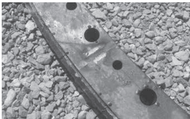
Obrázek č. 2 – stopa svaru po utrženém závěsu přivařeném na věnci
